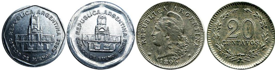
Izq: Acuñación con y sin collar. Der: Sin collar. Canto liso y modulo expandido.
